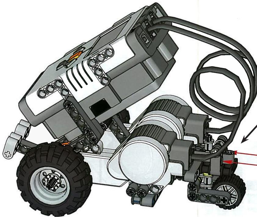
Le détecteur tactile se glisse à l'arrière du robot, juste au dessus de la roue arrière
