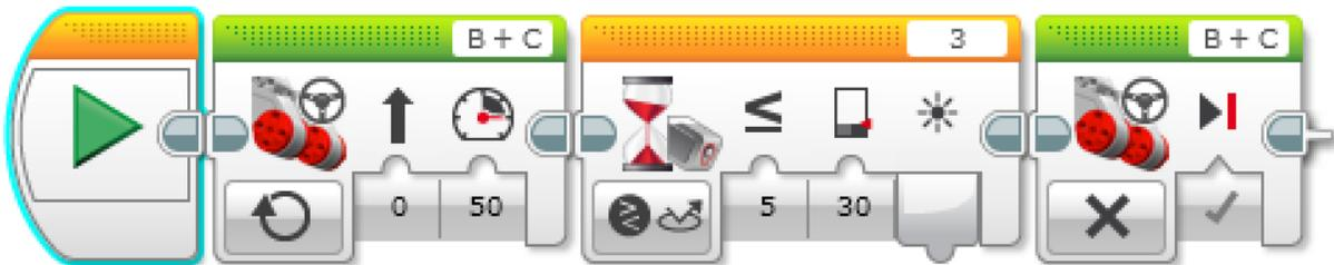
Pour le capteur de lumière, sélectionnez «Capteur de couleur», utilisez l'item «Comparer» et «Intensité de la lumière réfléchie».
